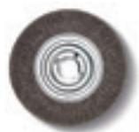
OCELOVÝ KARTÁČEK Ø 250 mm x 60 mm, velmi dobrá pevnost drátu v tahu, a potažmo velmi ekonomické řešení, upínací otvor Ø 51 mm, na tenkostěnné trubky a profily drát o tloušťce 0,2 mm. na univerzální použití drát o tloušťce 0,35 mm. na tlustostěnné trubky a profily a rychlé odhroťování drát o tloušťce 0,5 mm. Ocelové provedení
