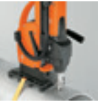
PŘÍPRAVEK PRO VRTÁNÍ TRUBEK včetně upínacího pásu, k vrtání otvorů na trubkách s Ø trubky 60 až 300 mm, 220 x 130 mm.
