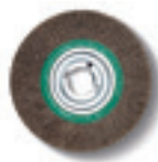
OCELOVÝ KARTÁČEK Ø 250 mm x 60 mm, velmi dobrá pevnost drátu v tahu, a potažmo velmi ekonomické řešení, upínací otvor Ø 51 mm, na tenkostěnné trubky a profily drát o tloušťce 0,2 mm. na univerzální použití drát o tloušťce 0,35 mm. na tlustostěnné trubky a profily a rychlé odhroťování drát o tloušťce 0,5 mm. Nerezové provedení:
